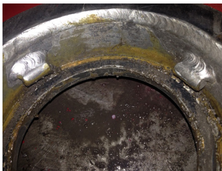
Uszkodzone gniazdo i płyta uszczelniająca niepraktycznej zasuwki po kilku tygodniach pracy.
